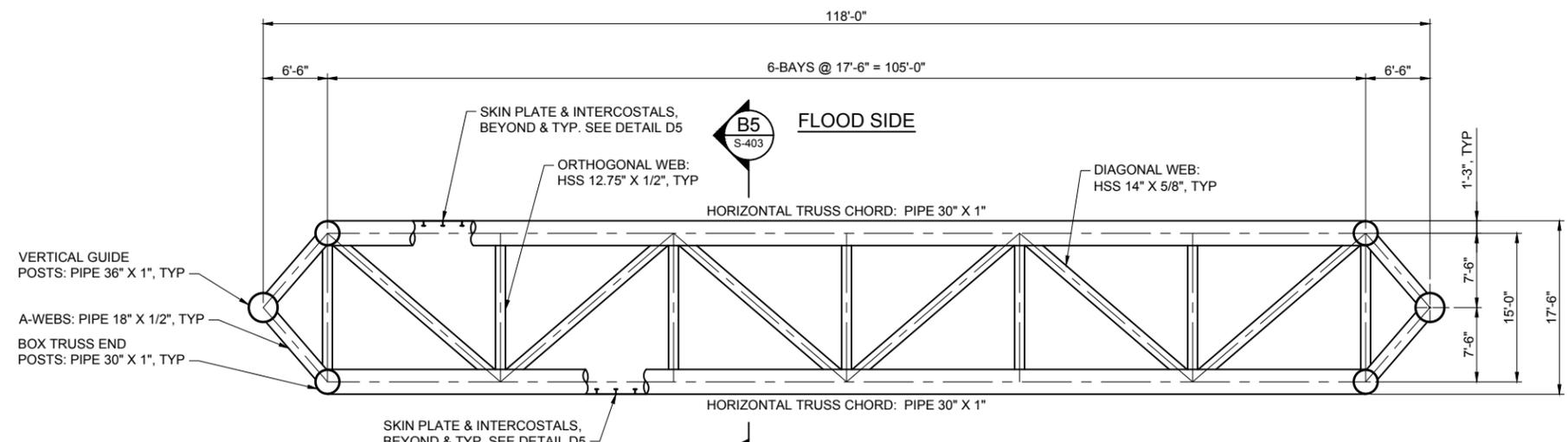
**D1** PLAN - VERTICAL LIFT GATE - TYPICAL HORIZONTAL TRUSS SECTION
